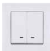
Illuminated One Way Switch 200-010102-201 10AX 250V ~ I EN 60669-1
